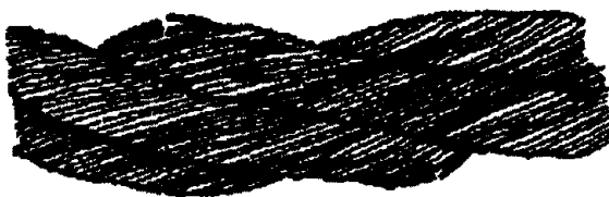
Рисунок 1. Обрывы и смещения проволок каната крестовой свивки.
