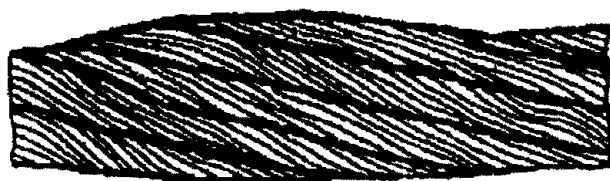
Рисунок 13. Местное увеличение диаметра каната.
